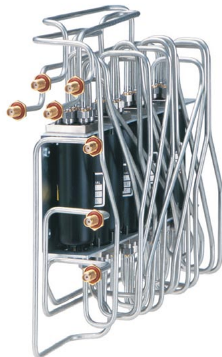
Innenansicht einer Schaltmatrix
